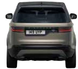
Spurweite hinten 1.687 mm
