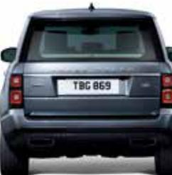
Spurweite hinten 1.685 mm
